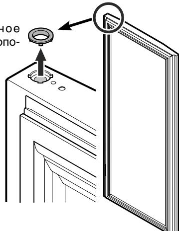
4. Снимите части опоры с шарнирного уголка.
