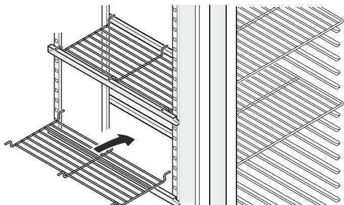
Прилагаемые полки установите на опорные шины.
