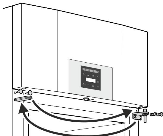
5. Верхние шарнирные уголки и бленды переставьте на противоположные стороны.
