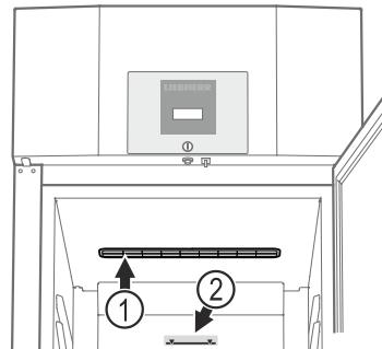
(1) Не разрешается закрывать вентиляционную решетку вентилятора циркуляционного воздуха внутри прибора!
