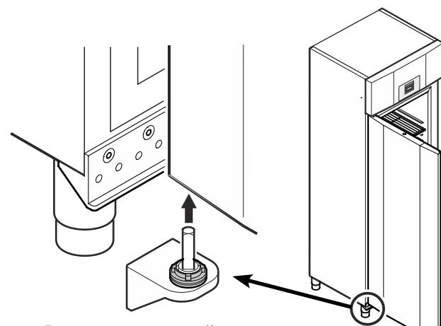
11. Вставьте шарнирный уголок с надетыми на него частями опоры в нижнюю опору двери.
