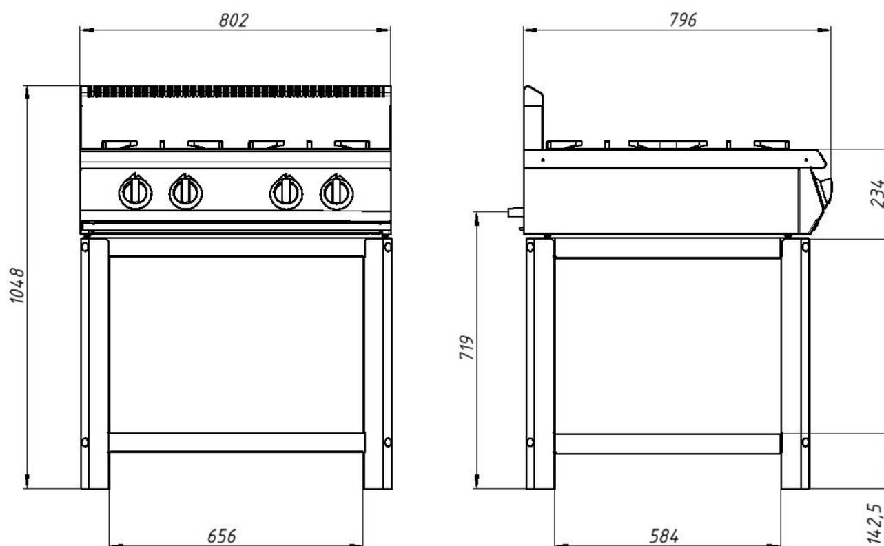
Рисунок 1 – Габаритные размеры плиты Ф4ПГ/800 (на подставке)
