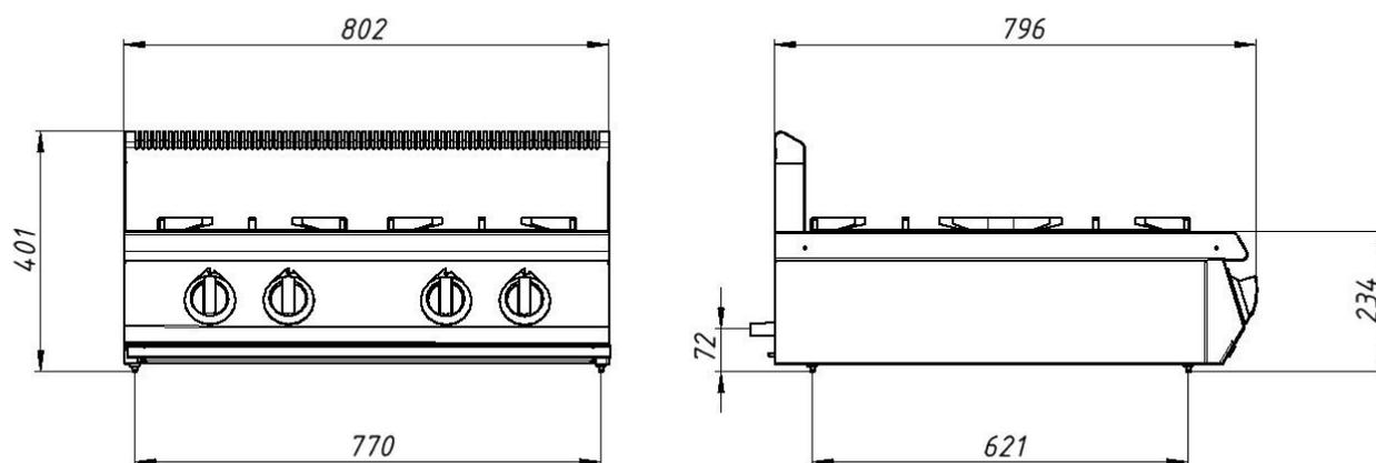
Рисунок 2 – Габаритные размеры плиты Ф4ПГ/800 (настольная)
