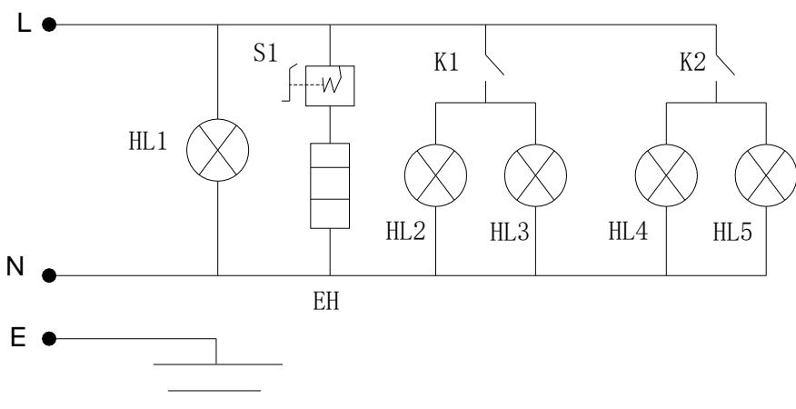
D1- Лампа питания R-Нагревательная трубка D2、 D3- Светодиодные лампы
