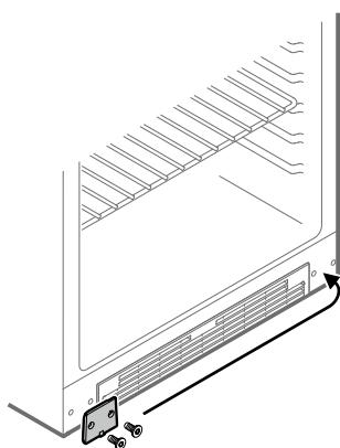
11. Переставьте защитную крышку на противоположную сторону.
