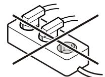
Не используйте автономные инверторы (преобразователи постоянного тока в переменный или трехфазный ток) либо энергосберегающие разъемы. Опасность повреждения электронного оборудования!
