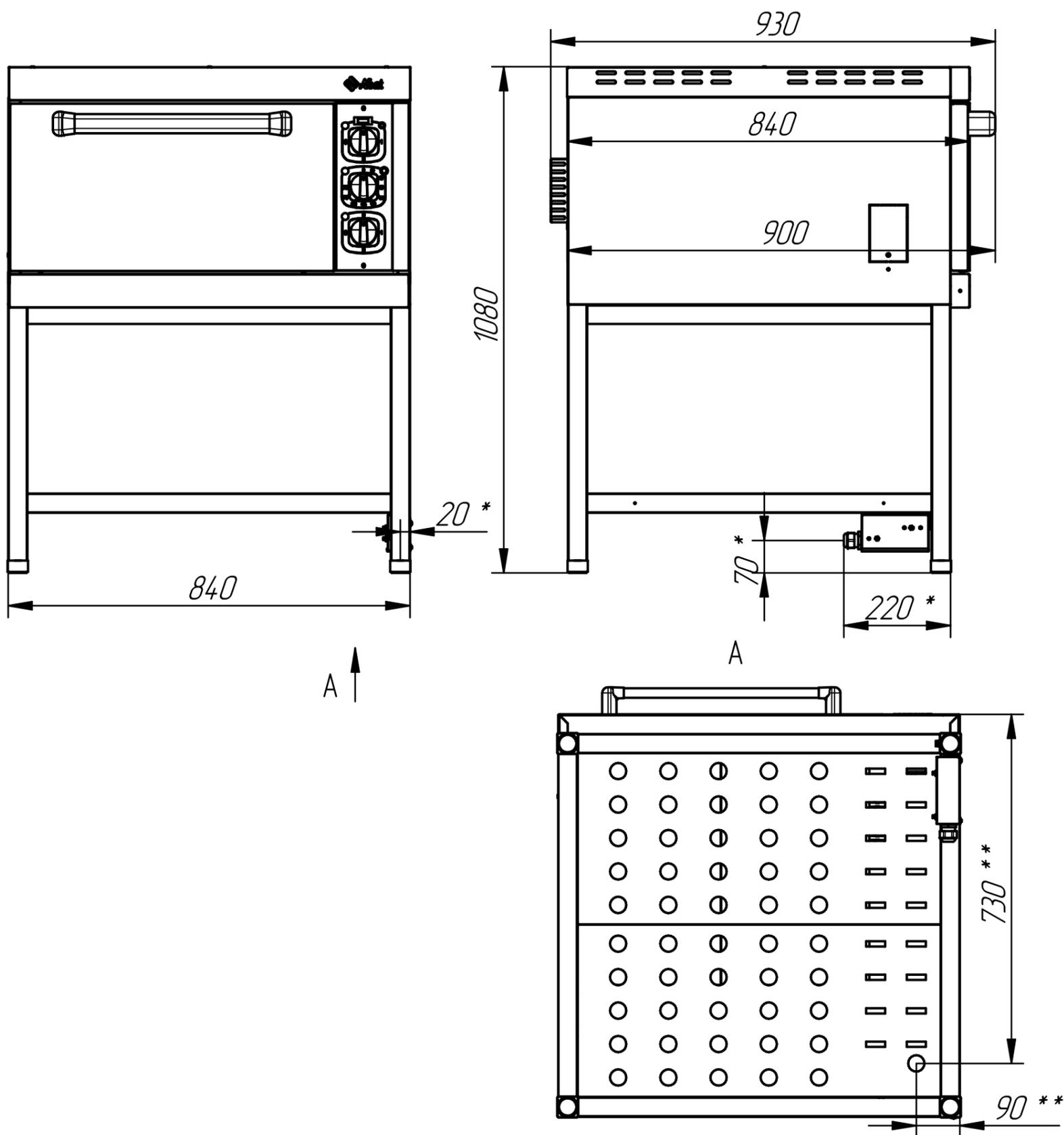
Жарочный шкаф состоит из полуфабрикатов и мелкоштучных кул. одна решетка 530x530x325x65мм, изг. Шкаф имеет разделенные нижние блоки ТЭН духовки 20 - 270°C предохраняет шкаф от возгорания при эксплуатации. Все элементы конструкции выполнены из стали. Шкаф имеет
