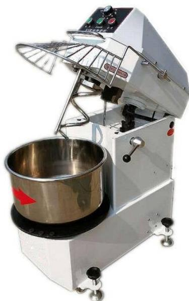
4. Для остановки работы нажмите кнопку «STOP», отключите питание, проверните рукоятку для поднятия верхней части машины и достаньте тесто. Для вынимания чаши
